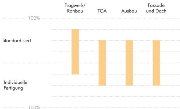
Abb. 21: Standardisierung in der Produktion der Subsysteme, Max Bögl Modul AG (eigene Darstellung)
