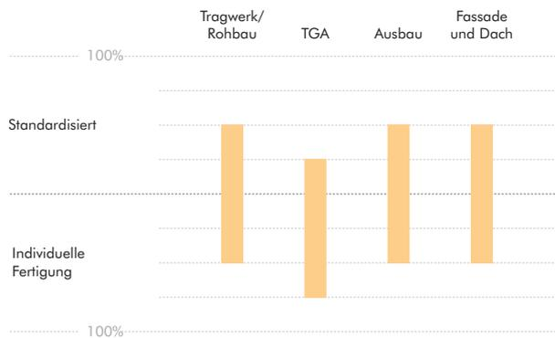
Abb. 36: Standardisierung in der Produktion der Subsysteme, Sisco Oyj (eigene Darstellung)
