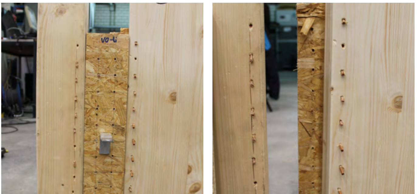
Abbildung 73: Versagen der Holznägel auf Biegung (links), genauere Betrachtung (rechts), Foto Elena Hetagurova, 2019, Pirmin Jung Deutschland GmbH
