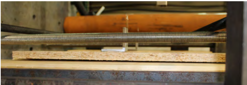
Abbildung 72: Ablösen der OSB-Platte von den Holzquerschnitten, Foto Elena Hetagurova, 2019, Pirmin Jung Deutschland GmbH
