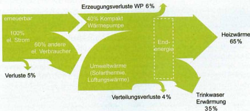
Das Minihaus deckt seinen Energiebedarf von 40 kWh/(m<sup>2</sup>a) weitestgehend regenerativ. Es wird mit einer Wärmepumpe beheizt, die den Wärmebedarf überwiegend aus der Umwelt bezieht. Der notwendige Hilfsstrombedarf wird durch Ökostrom gedeckt.
