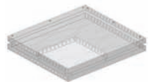
schichtweiser Aufbau der Moduplatten
