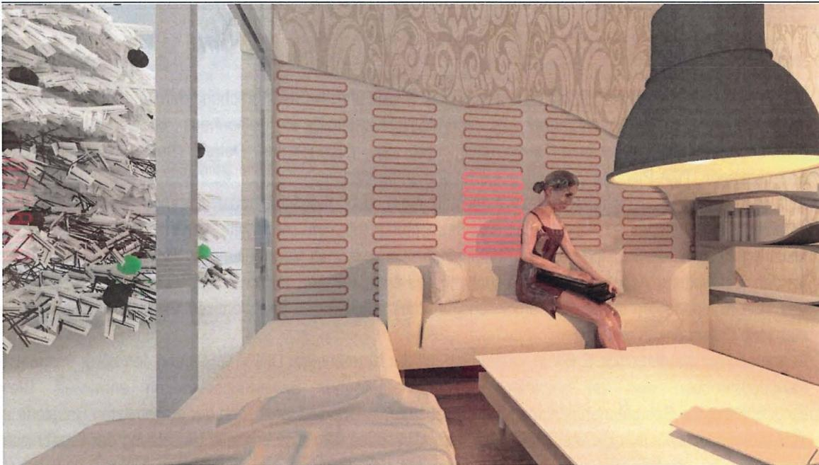
Abbildung 1: Selektiv aktivierte Heizelemente erzeugen nur Wärme, wo sie gebraucht wird.
