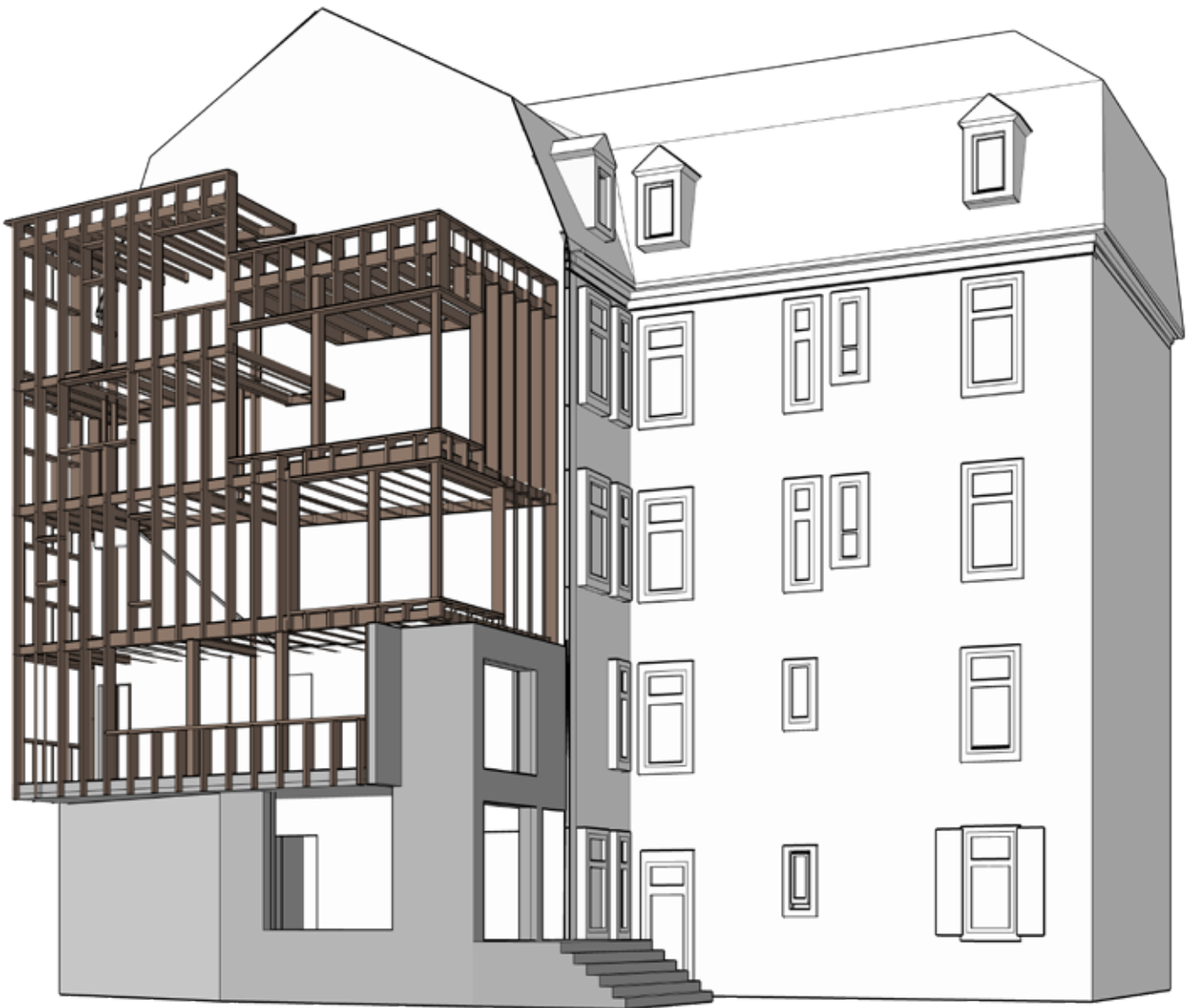
3D-Darstellung der Holzkonstruktion des Minihauses
