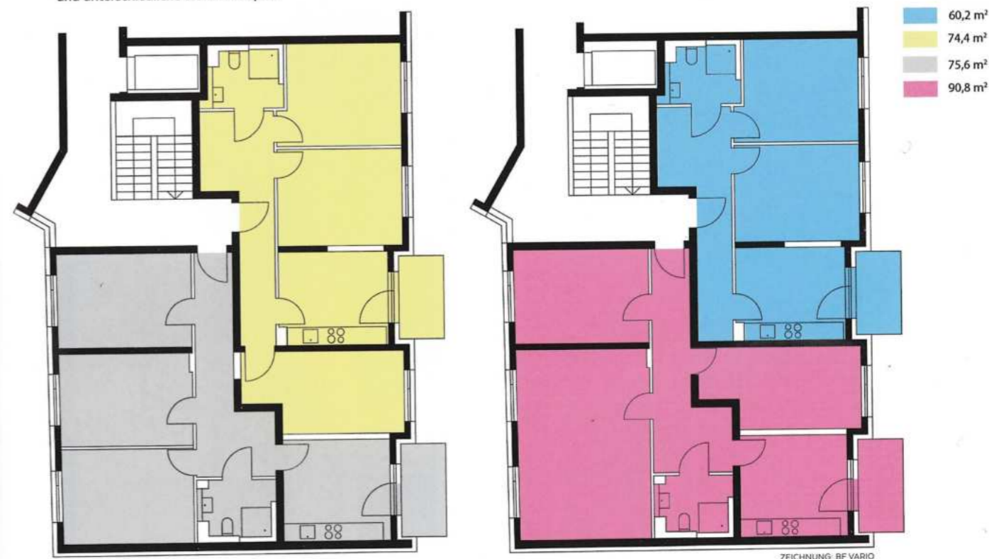
Chemnitz: Vorbereitete Durchbrüche erleichtern zukünftige Umbauten und unterschiedliche Wohnkonzepte.
