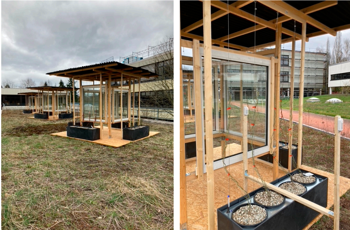
Abbildung 56 Aufbau der Teststände mit Sensorik zur Messung der Temperatur und Luftfeuchtigkeit. [Foto: © Van Lier, Kilian.]
