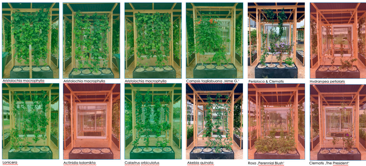
Abbildung 59 Auswertung Entwicklung der Teststände nach einer Vegetationsperiode (grün dargestellt sind die Pflanzen mit guter Entwicklung, rot dargestellt sind die Pflanzen mit einer schlechten Entwicklung im Begrünungsaufbau, ohne farbliche Markierung funktioniert, ist jedoch nicht vital). [Fotos und Bearbeitung: © Van Lier, Kilian]
