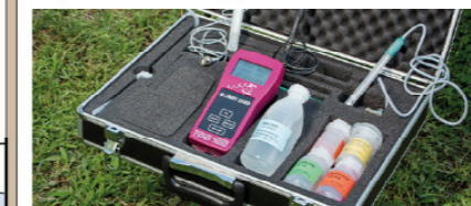
Multifunktionsmessgerät COMBI 5000 pH-Messung, EC-Messung, Aktivitäts-Messung, Feuchte- & Temperaturmessung
