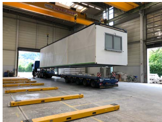
Abb. 6: ALHO: Produktionsschritte Rohbau, Innenausbau, Fassade; Abtransport eines Fertigen Moduls (Fotos: eigene Aufnahmen)
