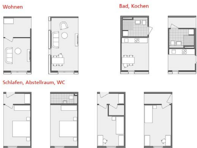
Abb. 14: Beispielhafte Modultypen des maxmodul-Systems (Quelle: Firmengruppe Max Bögl)
