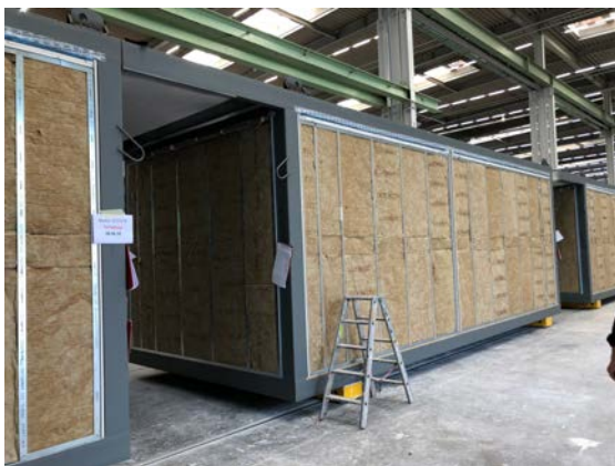
Abb. 6: ALHO: Produktionsschritte Rohbau, Innenausbau, Fassade; Abtransport eines Fertigen Moduls (Fotos: eigene Aufnahmen)
